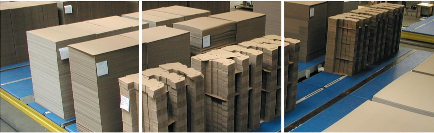
Les méthodes traditionnelles d'enlèvement de produits via chariots élévateurs ne sont plus une option économique pour l'usine de carton ondulé moderne, l'investissement dans un système de traitement intelligent intégré incorporant des bandes modulaires en plastique est devenu la nouvelle norme pour l'industrie du carton ondulé.
